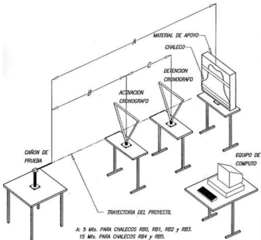
FIGURA 2. EQUIPO DE ENSAYO BALISTICO.
